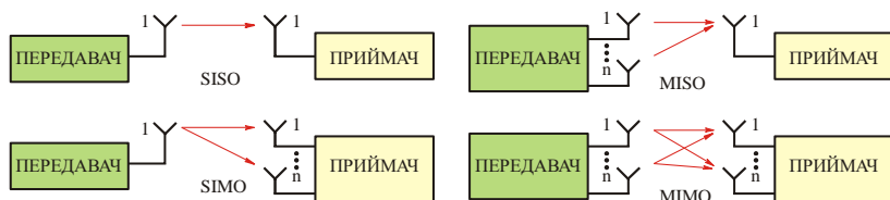
Рис. 2. Представлення каналів зв'язку: SISO, SIMO, MISO, MIMO
