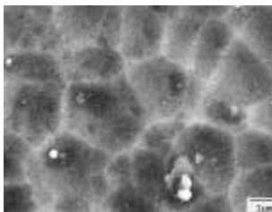
Рис. 1. Морфология поверхности покрытия TiN-Ti (наружный слой TiN)
