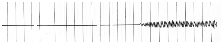
Рис. 3. Вибрографирование административного корпуса при запуске компрессора
