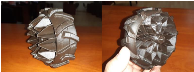
Рис. 3. Виготовлена модель колеса робомашинки на 3D-принтері
