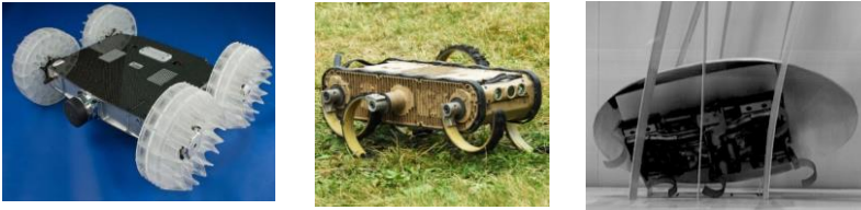
Рис. 1. Приклади відомих роботизованих машинок: «Sand Flea» (Boston Dynamics) (а), машинка Rhex (Boston Dynamics) (б), робот-тарпан (Каліфорнійський університет) (в)
