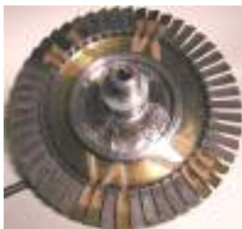
Рис.1. Биметаллический блиск с неохлаждаемыми лопатками из ЖС32 моно, диск – ЭП741НП
