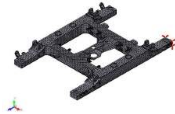
Рис.1. Конечно-элементная модель тележки дизель поезда
