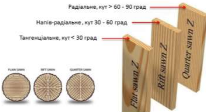
Рис. 3. Зарубіжний аналог класифікації пилопродукції залежно від напрямку річних кілець в торцевій частині пиломатеріалу
