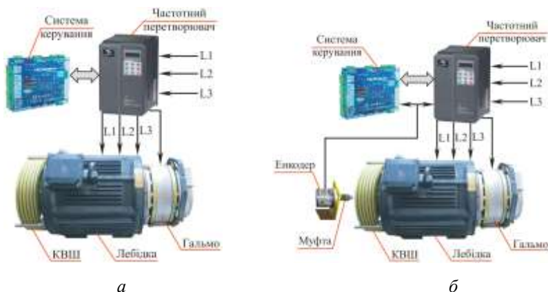
Рис. 3. Схема під'єднання лебідки ЛЛБ-06 на базі асинхронного двигуна АДБХ180L12ЛБУЗ:
