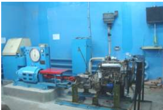
Рис. 1 – Загальний вигляд гальмівної установки з дизелем CY4102BZQ
