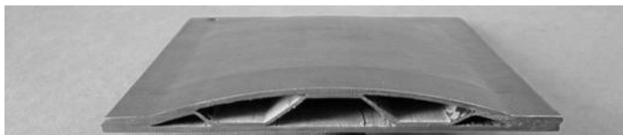
Рис.1. Конструкция плоского образца полый лопатки с наполнителем из гофрированного листа из титанового сплава
