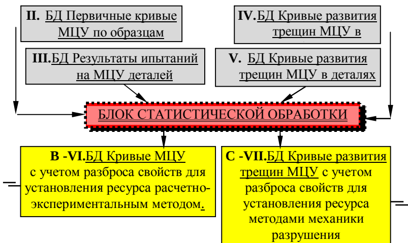
Рис. 1. Структура комплекса банк данных “Малоцикловая усталость конструкционных материалов для деталей ГТД”
