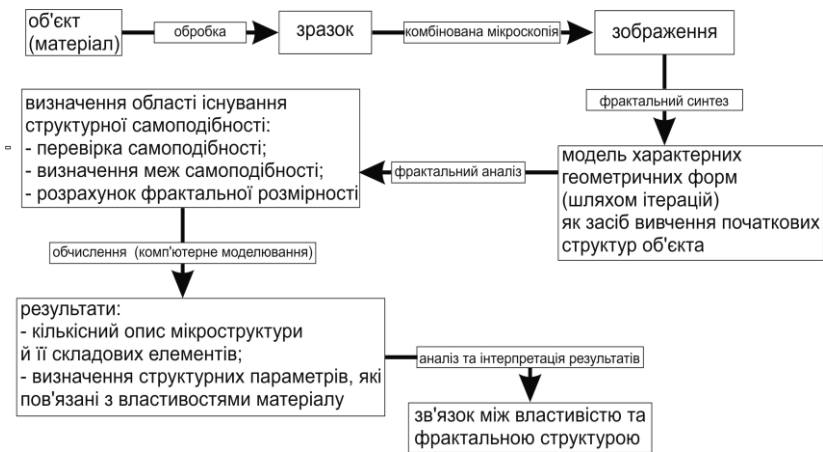
Рис. 1. Інформаційна модель дослідження структурних характеристик матеріалу на основі фрактального аналізу
