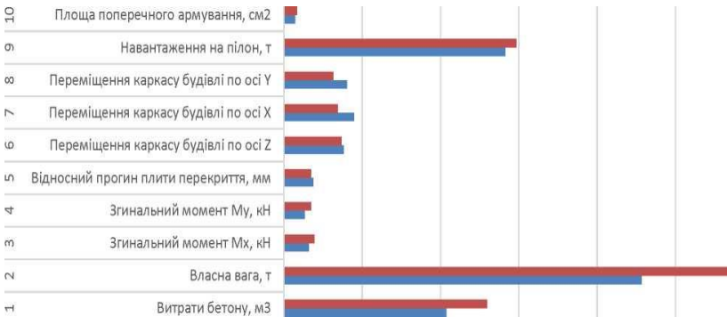
Рис. 4. Діаграма порівняння розрахункових показників дослідних плит перекриття
