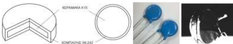
Рис. 1. Дисковий конденсатор і руйнування його кераміки
