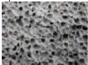
Рис. 1. Порообразная структура ячеистых бетонов
