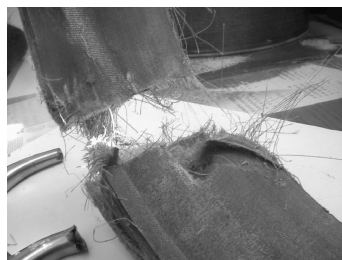
Рис. 3 Разрушенный корпус со стороны удара лопатки.
