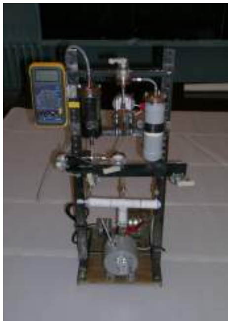
Рис. 1. Установка очистки трещин деталей из металлических сплавов
